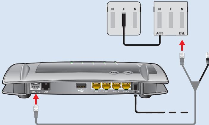
2. Stecken Sie das kurze, graue Kabelende in die passende Buchse des DSL-Splitters.
