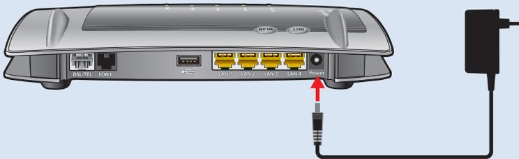
3. Stecken Sie das Netzteil in eine Steckdose der Stromversorgung. Die Leuchtdiode „Power / DSL“ beginnt nach einigen Sekunden zu blinken und signalisiert damit die Betriebsbereitschaft der FRITZ!Box.
